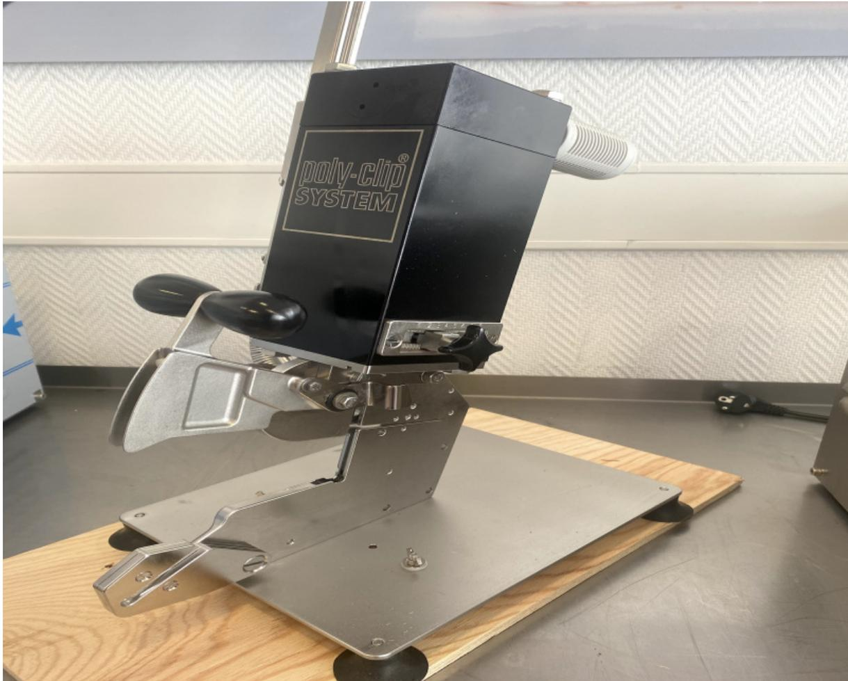
**Bilder zu Einzel-Clip-Maschine SCD 700**
